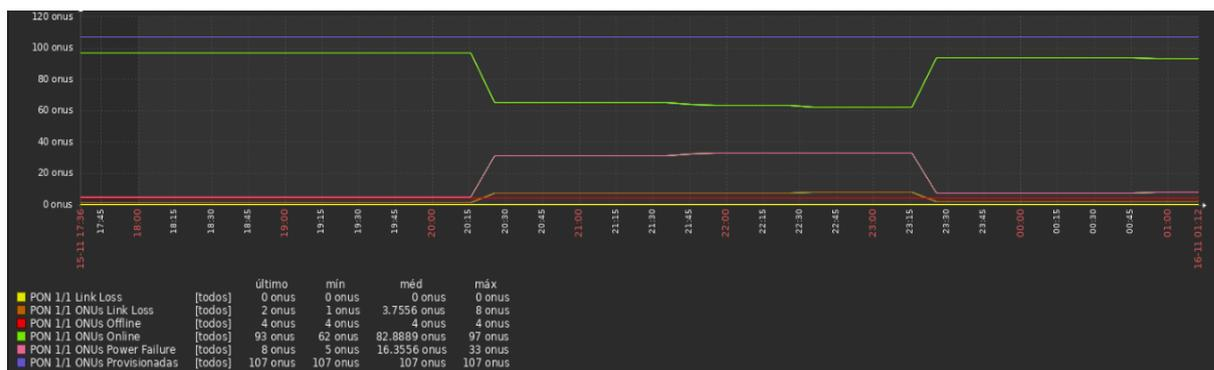
**Figura 1 - Quedas de Cpes no Bairro do Sul de Maringá (15/11/2024 às 20:15).** Barra Azul: Total de quedas de Cpes detectadas. Barra Rosa: Quedas devido a falta de energia. Barra Amarela: Quedas causadas por rompimento físico de link ("link loss"). Observação: A análise indicou que as quedas estão relacionadas a condições climáticas adversas (chuva intensa), diagnosticando falta de energia como principal causa. A decisão operacional evitou deslocamento em condições inseguras.
