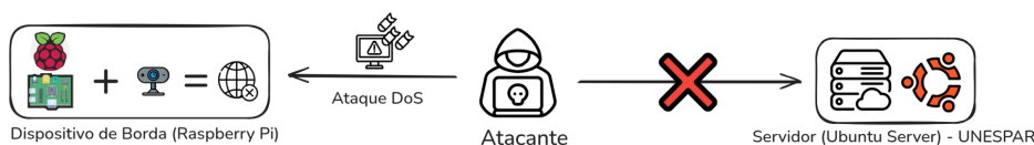
Figura 12 – Diagrama demonstrando o Ataque DoS do tipo SYN Flood
