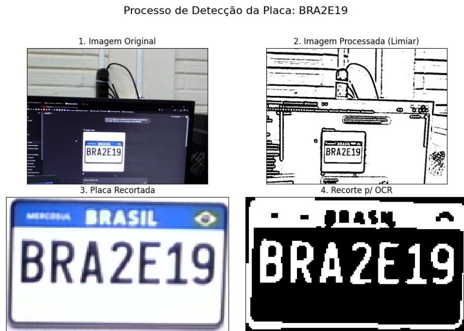
Figura 13 – Placa analisada e processada pelo Raspberry Pi
